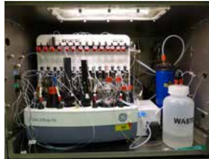
Radiosynthesizer (GE) zur Produktion von weiteren F-18-Tracern.
