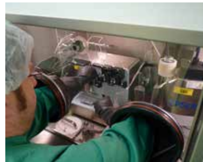
Radiopharmazeutischer Isolator für die sterile Abfüllung der Radiopharmaka.
