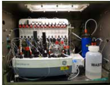
Radiosynthesizer (GE) zur Produktion von weiteren ^{18}\text{F} -Radiopharmaka.
